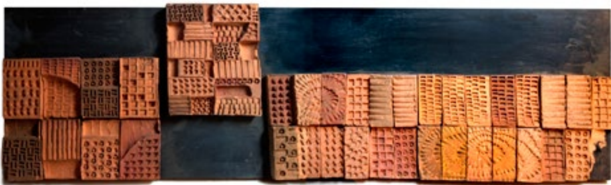
Maqueta con varias placas de terracota. Muestras relacionadas con el revestimiento cerámico del edificio de la calle General Moscardó, 20, Madrid [Fotos: JP. Colección Luis Cubillo de Arteaga]
